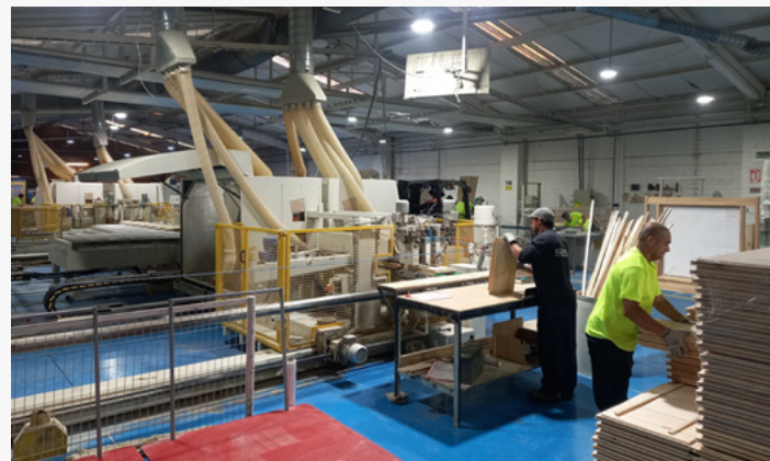
Máquina escuadradora doble de alta precisión.
