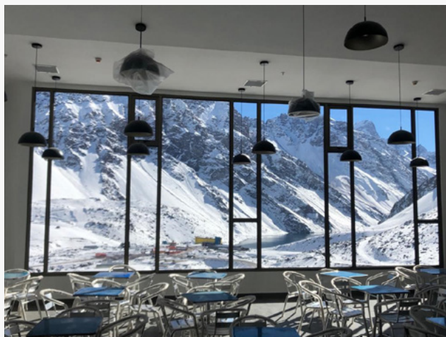
Vidrio Pilkington Low-e en Complejo Fronterizo Los Libertadores, Los Andes.
