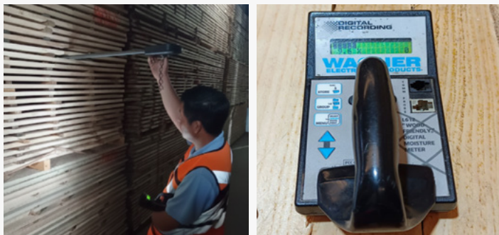
Control de humedad durante (Izquierda) y al término del ciclo de secado (Derecha).
